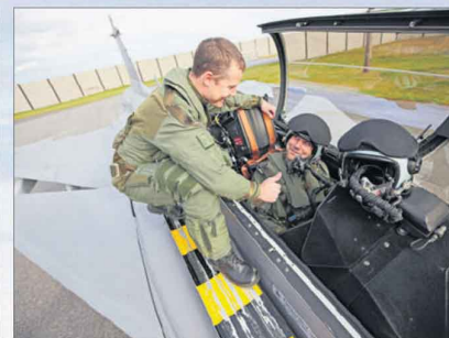
La jungle des sangles Dans un cockpit, il ne faut pas oublier certaines ceintures: celles qui bloquent les mollets pour empêcher les jambes de trop se déplacer lors de loopings, celle pour le bateau gonflable en cas d'amerrissage. Ensuite, il y a une foule de boutons et de leviers à actionner: l'oxygène, le siège éjectable, la radio. La tenue anti-G doit aussi être reliée au système électronique de l'avion.
